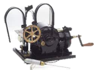
1932 pacemaker externe. Appareil à manivelle
