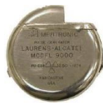
1972 pile nucléaire Plutonium (30 ans)
